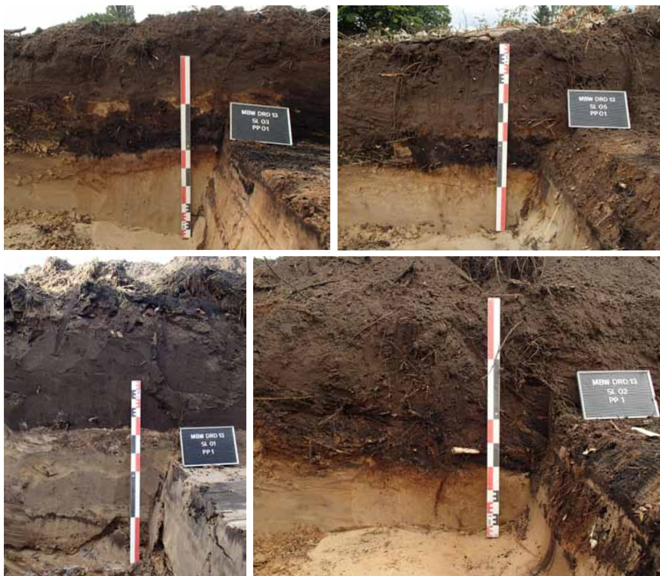
Figuur 10 t.e.m. 13: Veldopnames van bodemprofielen met verschillende bewaring van de A, B en C horizonten
