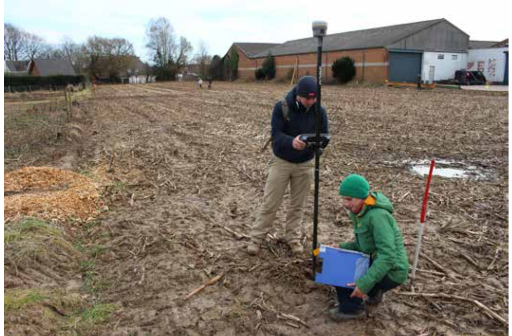
Figuur 10: De betekenisvolle objecten krijgen een uniek nummer toegekend en hun locatie wordt met een GPStoestel opgemeten
